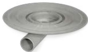
Scarico centrale a deflusso laterale in polipropilene di altezza 75 mm con uscita diametro 50 mm, senza sifone, da utilizzare come accessorio in combinazione con Aquaform Out Kit nei sistemi AquaExpert.
